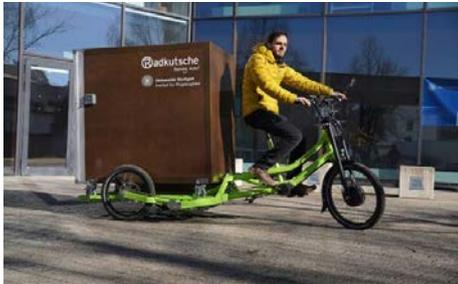
**Für ein elektrisch betriebenes Schwerlast-Fahrrad hat die Universität Stuttgart ein Akkuwechsel-Containersystem erfolgreich entwickelt. Foto: Universität Stuttgart / IFB**
